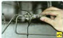
2. ...выньте наконечник из кронштейна на балке задней подвески и слейте тормозную жидкость из шланга в емкость.
