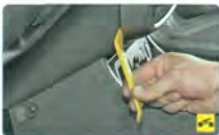
4. Подденьте монтажной лопаткой нижнюю накладку центральной консоли...
