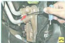
8. Выверните винт крепления прижимной пластины патрубков...
