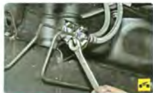
1. Для замены шланга тормозного механизма заднего колеса отверните гайку крепления тормозной трубки к нижнему наконечнику шланга...
