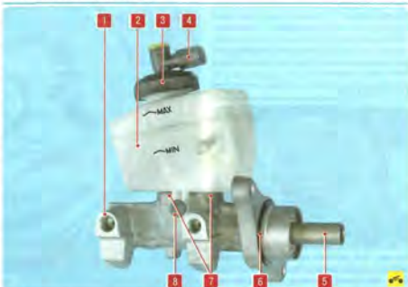
Рис. 9.2. Главный тормозной цилиндр с бачком: 1 – главный тормозной цилиндр; 2 – бачок главного тормозного цилиндра; 3 – пробка бачка; 4 – датчик уровня тормозной жидкости; 5 – толкатель поршня; 6 – уплотнительное кольцо; 7 – соединительные втулки (на фото не видны, так как закрыты бачком); 8 – штифт крепления бачка
