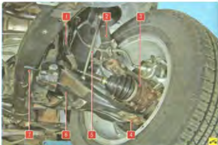
Рис. 7.1. Передняя подвеска: 1 – штанга стабилизатора поперечной устойчивости; 2 – амортизаторная стойка; 3 – поворотный кулак; 4 – шаровая опора; 5 – стойка стабилизатора поперечной устойчивости; 6 – рычаг передней подвески; 7 – подрамник передней подвески
