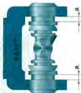
Рис. 6.8. Схема запрессовки подшипников карданного шарнира
