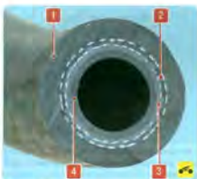
Рис. 12.3. Конструкция шланга гибкой вставкой: 1 – наружная защитная оболочка; 2 – тканевый корд стального каркаса; 3 – пластмассовый термостойкий слой; 4 – внутренний маслостойкий слой
