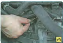
25. Отожмите фиксатор колодки жгута проводов датчика давления масла...
