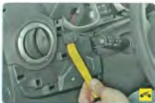
10. Подденьте монтажной лопаткой левую накладку комбинации приборов...
