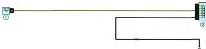
Схема 9. Дальний свет фар: 1 - блок предохранителей в салоне; 3 - левая блок-фара; 4 - правая блок-фара
