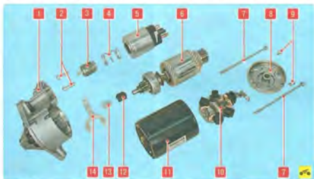
Рис. 10.5. Детали стартера: 1 – крышка со стороны привода; 2 – винты крепления тягового реле; 3 – якорь реле; 4 – возвратная пружина; 5 – корпус тягового реле; 6 – ротор стартера в сборе с муфтой свободного хода; 7 – болт крепления крышки со стороны привода; 8 – крышка со стороны коллектора; 9 – винт крепления крышки со стороны коллектора; 10 – шайба-держатель; 11 – корпус стартера; 12 – резиновое уплотнение; 13 – опора рычага привода; 14 – рычаг привода
