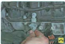
23. ...и отсоедините колодку от датчика.
