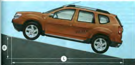
Рис. 9.5. Проверка стояночного тормоза
