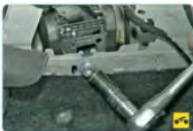
17. Выверните болт крепления катушки ремня безопасности.
