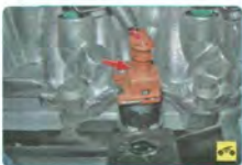
24. Сожмите фиксатор колодки жгута проводов датчика детонации и отсоедините колодку от датчика.
