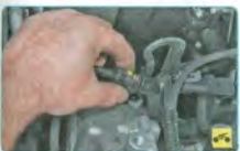
20. Сожмите фиксаторы шланга продувки адсорбера...
