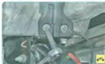
5. Отверните две гайки нижнего крепления кожуха жгута проводов.
