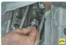
29. ...и отсоедините колодку от датчика.
