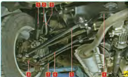
Рис. 7.5. Задняя подвеска автомобиля 4WD: 1 – амортизаторная стойка; 2 – стойка стабилизатора поперечной устойчивости; 3 – штанга стабилизатора поперечной устойчивости; 4 – подрамник; 5 – задний поперечный рычаг; 6 – передний поперечный рычаг; 7 – продольный рычаг; 8 – кулак
