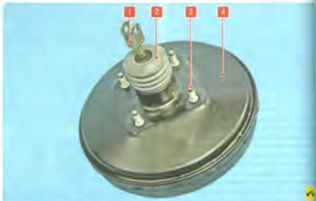
Рис. 9.3. Вакуумный усилитель: 1 – толкатель; 2 – защитный чехол с фильтром; 3 – шпилька крепления вакуумного усилителя; 4 – корпус усилителя
