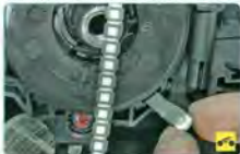
Рис. 10.8. Номера выводов переключателя очистителя и омывателя ветрового стекла
