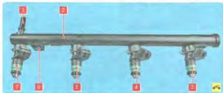
Рис. 5.13. Топливная рампа: 1 – штуцер встанка подачи топлива; 2 – рампа; 3, 4, 5, 7 – форсунка; 6 – крепежной крепления топливной рампы
