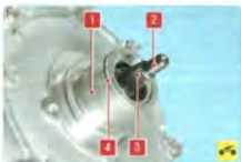
13. После снятия шкива осмотрите шлицы 2 и резьбовой наконечник 3 вала, канавку 4 для стопорного кольца и посадочную поверхность 1 шейки подшипника (для наглядности катушка магнита снята). При их износе или повреждении компрессор подлежит замене.
