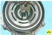
10. С помощью разжимного съемника снимите стопорное кольцо подшипника шкива.
