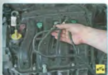
17. Отсоедините колодки жгута проводов от катушек зажигания...
