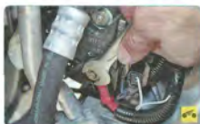
27. Отсоедините провода от генератора (см. «Снятие и установка генератора», с. 207).
