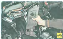
7. ...и снимите усилитель.
