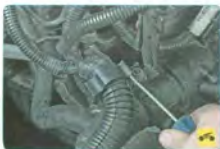
30. Подтяните скобу крепления жгута проводов...
