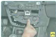
5. ...и продвигайте блок внутрь панели.
