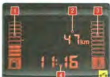
Рис. 1.10. Дисплей бортового компьютера: 1 - указатель уровня топлива; 2 - счетчик общего пробега; 3 - указатель температуры жидкости в системе охлаждения двигателя; 4 - часы
