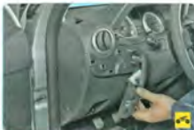
3. ...и, преодолевая усилие держателей, снимите ее.
