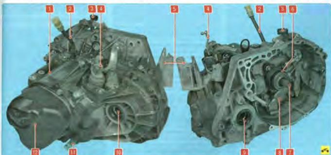
Рис. 6.2. Механическая коробка передач JRS: 1 – картер коробки передач; 2 – сальник; 3 – датчик положения коленчатого вала; 4 – механизм переключения передач; 5 – кронштейн крепления тросов управления коробкой передач; 6 – механизм выключения сцепления; 7 – левый вал коробки передач; 8 – картер сцепления; 9 – сальник привода правого колеса; 10 – сальник привода левого колеса; 11 – выключатель света заднего хода; 12 – задняя крышка
