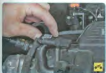
18. Отожмите фиксатор колодки жгута проводов датчика абсолютного давления во впускной трубе...
