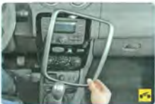
5. ...и, преодолевая усилие держателей, снимите ее.
