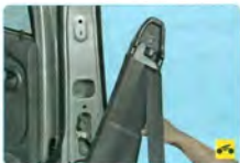
12. Отведите нижнюю облицовку центральной стойки от кузова.
