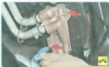
10. Выверните винты крепления радиатора к корпусу отопителя, отожмите фиксаторы...
