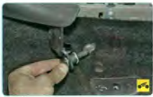
14. ...извлеките болт и отсоедините пряжку ремня от кузова.
