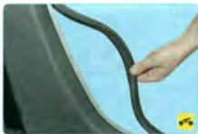
11. Снимите уплотнители дверей с отбортовок центральной стойки кузова и с облицовки.
