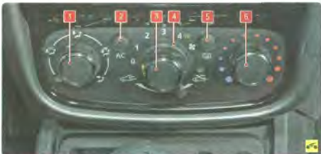
Рис. 1.12. Блок управления системой отопления, кондиционирования и вентиляции салона: 1 – регулятор распределения потоков подаваемого в салон воздуха; 2 – выключатель кондиционера; 3 – переключатель режима работы вентилятора; 4 – переключатель режима рециркуляции; 5 – выключатель электродобогрева стекла двери багажа; 6 – регулятор температуры подаваемого в салон воздуха.
