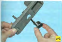
8. Вытолкните из отверстия панели втулку крепления патрона.
