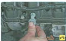
22. Отожмите фиксатор колодки жгута проводов датчика температуры воздуха во впускной трубе...
