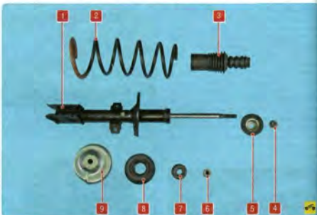
Рис. 7.2. Детали амортизаторной стойки: 1 – амортизатор; 2 – пружина; 3 – буфер сжатия с защитным чехол; 4 – гайка верхнего крепления амортизаторной стойки; 5 – упорная шайба; 6 – гайка штока амортизатора; 7 – опорный подшипник; 8 – верхняя опора стойки; 9 – верхняя тарелка пружины.
