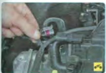
19. ...и отсоедините колодку от датчика.
