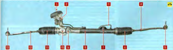
Рис. 8.1. Рулевой механизм: 1 – вал-шестерня рулевого механизма; 2 – распределительный клапанный механизм; 3 – трубопроводы подачи рабочей жидкости; 4, 12 – контргайки наконечников рулевых тяг; 5, 13 – шаровые шарниры наружных наконечников рулевых тяг; 6, 11 – защитные чехлы тяг; 7 – правый кронштейн крепления механизма; 8 – гидроцилиндр; 9 – левый кронштейн крепления механизма; 10 – рейка рулевого механизма
