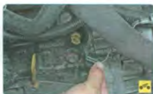
26. ...и отсоедините колодку от датчика.
