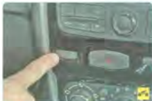
...задние двери – кнопкой блокировки, нажав на нее до щелчка...
