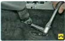
13. Выверните болт нижнего крепления ремня безопасности...
