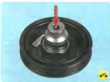
16. Запрессуйте новый подшипник. При запрессовке прикладывайте усилие только к наружной обойме подшипника.
