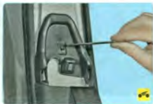
10. ...и один винт верхнего крепления.
