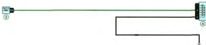
Схема 10. Ближний свет фар: 1 - блок предохранителей в салоне; 3 - левая блок-фара; 4 - правая блок-фара
