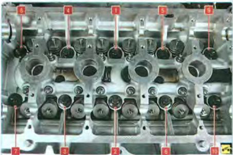
Рис. 5.6. Порядок затяжки болтов крепления головки блока цилиндров
