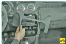
7. ...и, преодолевая усилие держателей, снимите ее.
