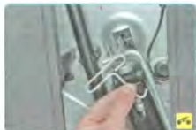
5. Снимите приспособление для демонстрации колпаков колес...
