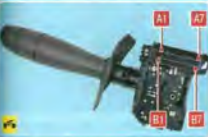
Рис. 10.8. Номера выводов переключателя очистителя и омывателя ветрового стекла
