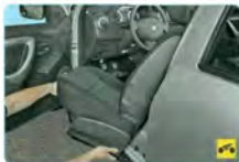
21. При необходимости снятия замка переднего ремня безопасности снимите переднее сиденье.
