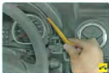
8. Подденьте монтажной лопаткой верхнюю накладку комбинации приборов...
