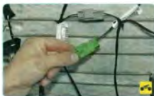
22. Снизу подушки сиденья нажмите на фиксатор нижней колодки жгута проводов датчика непристегнутого ремня безопасности...
