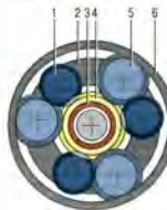
Рис. 6.6. Планетарный редуктор системы Равинь: 1 – зубчатый сателлит; 2 – водило; 3 – малая солнечная шестерня; 4 – большая солнечная шестерня; 5 – корпусный сателлит; 6 – внешняя шестерня
