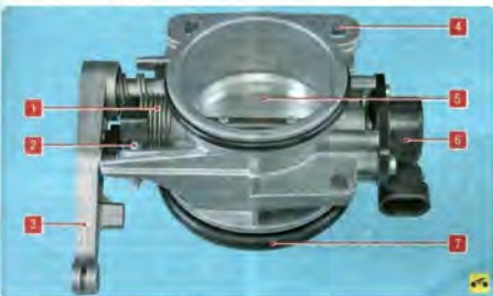
Рис. 5.15. Дроссельный узел двигателя K4M: 1 – возвратная пружина; 2 – винт регулировки положения заслонки; 3 – рычаг привода заслонки; 4 – фланец крепления узла; 5 – дроссельная заслонка; 6 – датчик положения заслонки; 7 – уплотнительное кольцо
