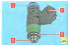
Рис. 5.14. Форсунка: 1 – уплотнительное кольцо; 2 – распылитель; 3 – электрический разъем обмотки электромагнита
