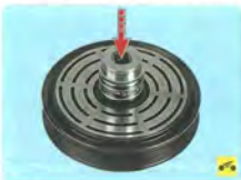
15. С помощью оправки подходящего диаметра выпрессуйте старый подшипник из шкива.
