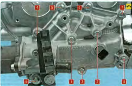
Рис. 5.11. Последовательность затяжки болтов крепления водораспределителя
