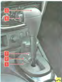
Рис. 1.13. Рычаг селектора управления автоматической коробкой передач: 1 – шкала ручного режима управления; 2 – шкала автоматического режима управления; 3 – выключатель режима трогания с места на скользкой дороге; 4 – кнопка блокировки включения передачи; 5 – рукоятка рычага.
