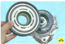
12. ...и спрессуйте шкив с посадочной шейки передней крышки компрессора.
