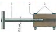
Рис. 5.9. Приспособление для притирки клапанов: 1 – металлический стержень; 2 – резиновый шланг; 3 – втулка чашки
