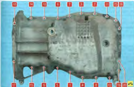
Рис. 5.7. Порядок затяжки болтов крепления масляного картера двигателя (для наглядности показано на снятом картере)
