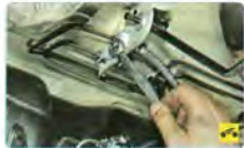
3. Аналогично отсоедините тормозную трубку от верхнего наконечника шланга...
