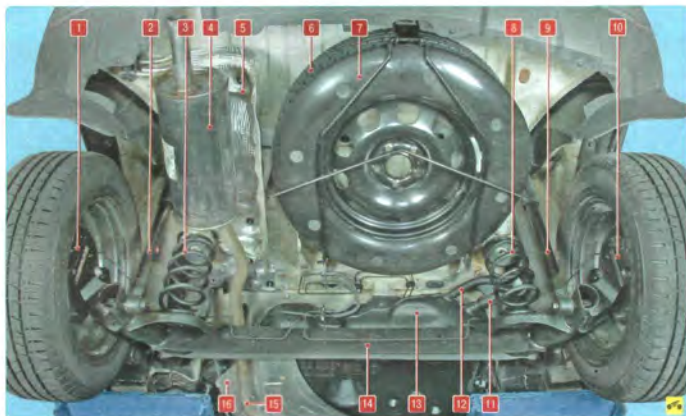
Рис. 1.5. Основные агрегаты автомобиля 2WD (вид снизу сзади): 1, 10 – тормозные механизмы задних колес; 2, 9 – амортизаторы задней подвески; 3, 8 – пружины задней подвески; 4 – основной слушитель; 5 – термозыскан основного слушителя; 6 – запасное колесо; 7 – держатель запасного колеса; 11 – наливная труба топливного бака; 12 – воздухоподводящая трубка наливной трубы; 13 – топливный бак; 14 – балка задней подвески; 15 – промежуточная труба; 16 – термозыскан промежуточной трубы
